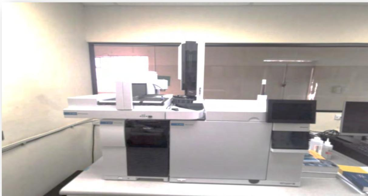
*Foto: Cromatógrafo de Gases acoplado a Detector Selectivo de Masas con Autoinyector ALS, Laboratorio de Sustancias Controladas del INACIF*
