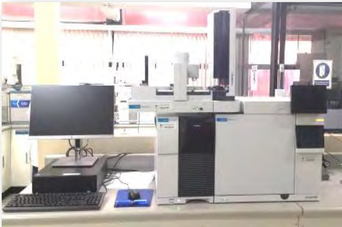
*Foto: Cromatógrafo de Gases acoplado a Detector Selectivo de Masas con Autoinyector ALS, Laboratorio de Toxicología del INACIF*
