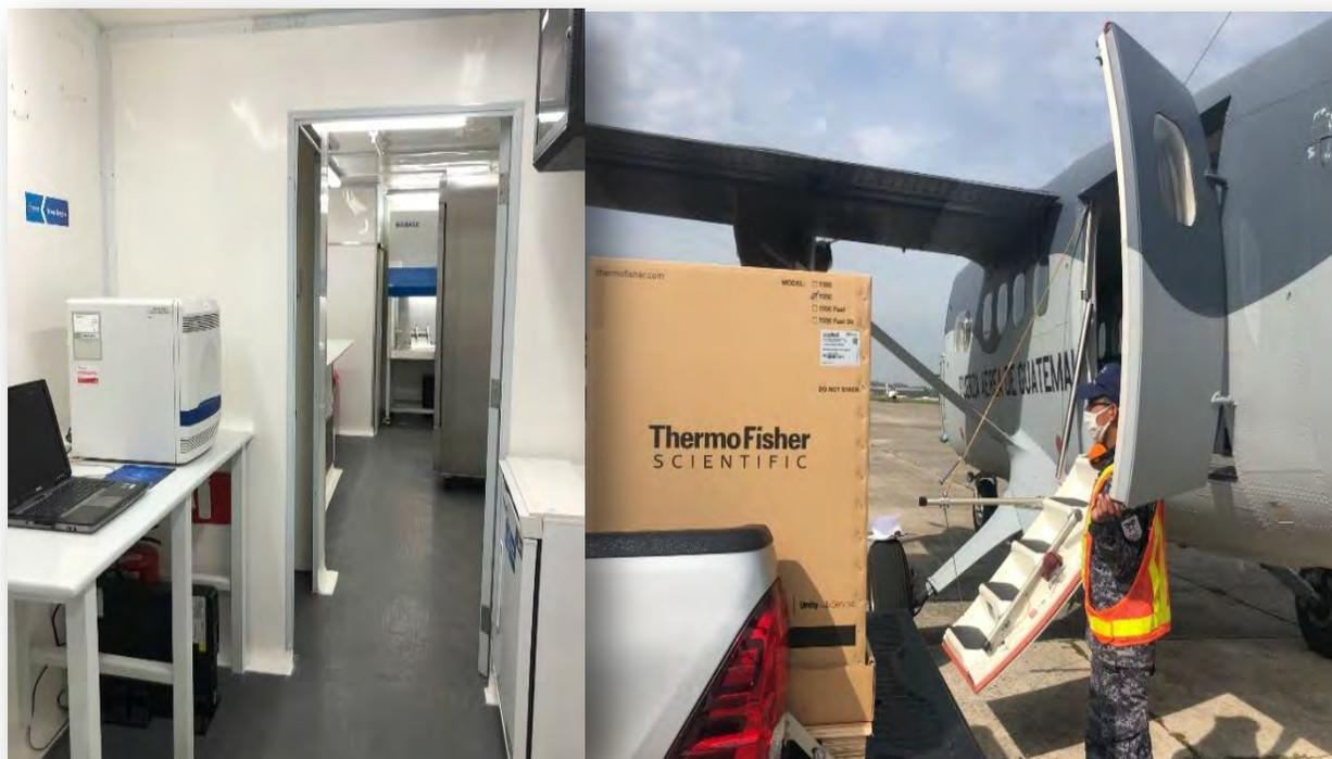
El personal especializado del INACIF como parte del apoyo logró trasladar, instalar los equipos, realizar las calibraciones espectrales, espaciales y del sistema óptico, verificar el desempeño de los equipos dentro del Laboratorio y capacitar al personal del Ministerio de Salud y Asistencia Social; logrando dejar un laboratorio móvil funcional con personal capacitado para su uso.
