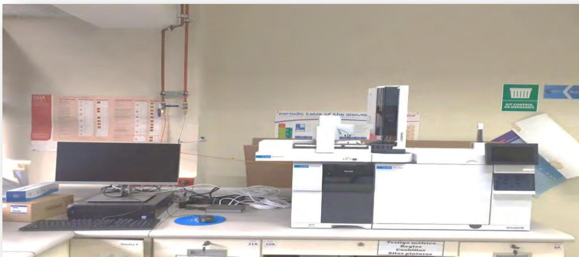
*Foto: Cromatógrafo de Gases acoplado a Detector Selectivo de Masas con Autoinyector ALS, Laboratorio de Físicoquímica del INACIF*
